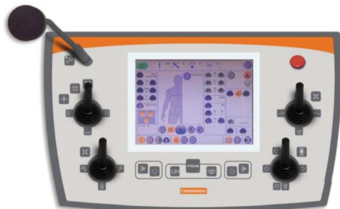
Facile à utiliser, cette console comporte un grand écran tactile et des commandes intuitives. Elle regroupe l'ensemble des mouvements de la table, des réglages du radiogène et des fonctions APR sur une seule interface. Le positionnement automatique contribue à réduire le temps de mise en place des examens.
