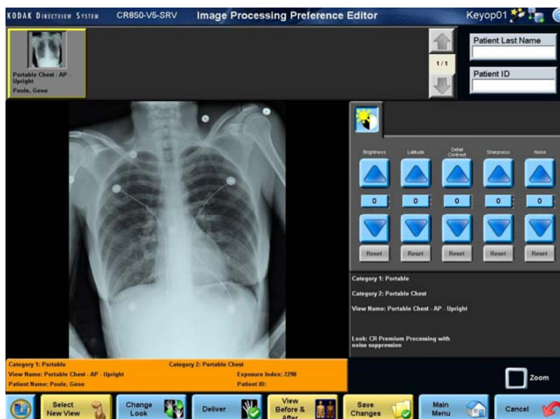
Rysunek 6 – Interfejs użytkownika z niezależnymi elementami sterującymi atrybutami jakości obrazu
