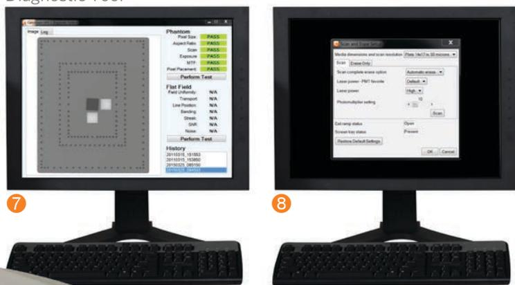
**7 Stato del sistema** - Il Diagnostic Tool (accessorio opzionale) permette all'utente di monitorare la stabilità del sistema secondo ASTM E2445.
