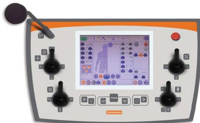
La console di facile utilizzo è dotata di un grande touch screen a colori e di comandi intuitivi. Integra in un'unica interfaccia efficiente tutti i movimenti del tavolo, le impostazioni del generatore e le funzioni APR. Il posizionamento automatico facilita l'impostazione rapida degli esami.
