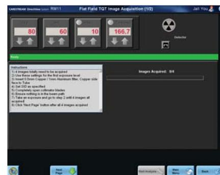
La schermata principale del Total Quality Tool permette all'utilizzatore di scegliere ed eseguire i test, verificare i risultati del test corrente, scartare l'ultimo test eseguito nel corso della sessione corrente, visualizzare una sintesi dei risultati dei test precedenti, e di accedere alla pagina per il test delle singole cassette.
