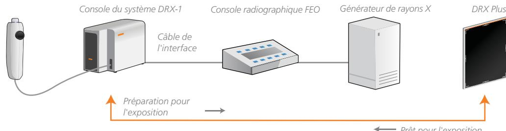
En **Mode détection du faisceau**, il n'y a aucune connexion par câble entre la console et le générateur FEO. Le détecteur DRX Plus capture automatiquement une image lorsque la console indique que le détecteur est prêt et qu'un faisceau de rayons X est détecté.
