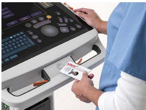
En outre, le système Carestream fait un bond technologique en avant avec son plateau en verre gravé collé sur un écran tactile de 19 pouces qui remplace les touches, boutons, molettes et autres trackballs physiques. Cette interface entièrement en verre peut aussi être nettoyée en un instant.
