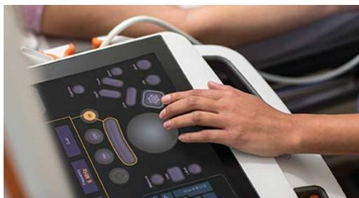
Le panneau de verre gravé est collé physiquement sur le panneau tactile en dessous. Ainsi, la console est imperméable à la poussière, aux salissures et aux liquides, y compris les gels et les fluides corporels.
