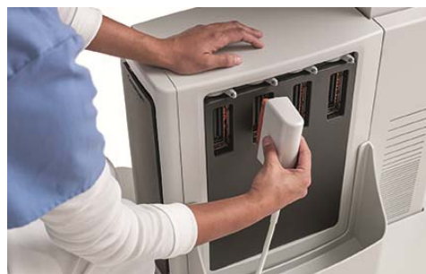
Bild 6 och 7: Flera givarportar tar bort behovet av att ändra givare genom anslutning. När det är nödvändigt att byta givare bör det kunna göras med en hand.
