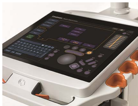
Bild 2: De kontroller som används oftast är grupperade och centrerade runt styrkulan, vilken är helt integrerad som pekfunktion på kontrollpanelen. Panelen kan flyttas från vänster till höger så att systemet kan anpassas bättre vid användning i undersökningsrum.
