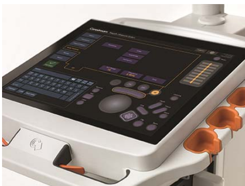
Figur 2: De hyppigst anvendte betjeningsknapper er grupperet og centreret omkring trackballen, der er fuldt integreret som en berøringsfunktion på kontrolpanelet. Panelet kan flyttes fra venstre til højre for at sikre fleksibiliteten, når systemet placeres i et undersøgelseslokale.
