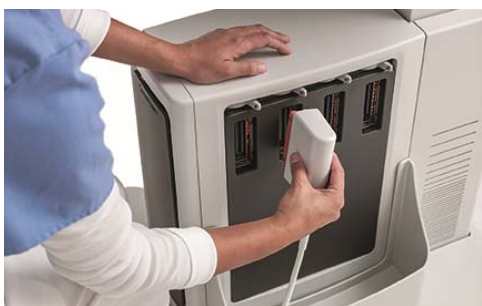
Figur 6 og 7: Flere transducerporte mindsker behovet for at skifte transducere ved at isætte dem. Det skal være nemt at skifte transduceren med én hånd, når den skal skiftes.
