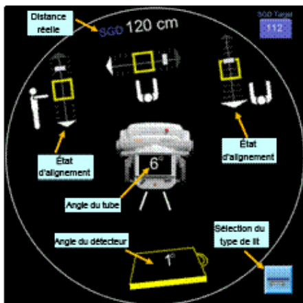
Figure 3 : L'affichage de l'assemblage tube-tête sur le système DRX-Revolution communique les informations sur la position de la source de rayons X et de la grille/détecteur en temps réel pour garantir un alignement correct.
