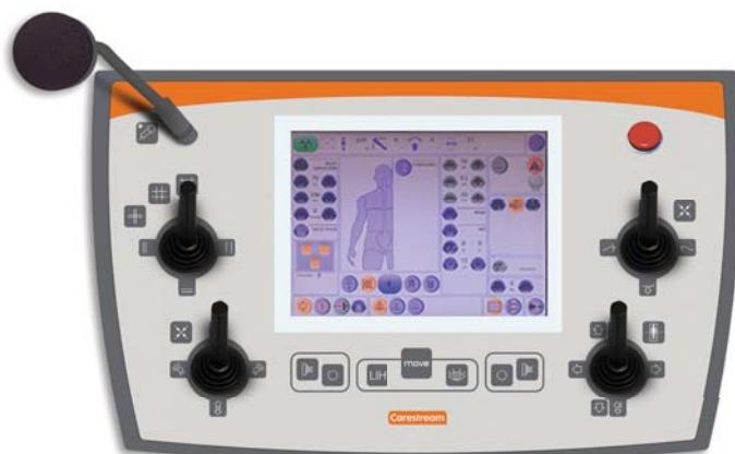
Diese benutzerfreundliche Konsole ist mit einem großen farbigen Touchscreen und intuitiven Bedienelementen ausgestattet. Alle Tischbewegungen, Generatoreinstellungen und APR-Funktionen können über eine einzige effiziente, integrative Oberfläche gesteuert werden. Mithilfe der automatische Positionierung lassen sich Untersuchungen schneller vorbereiten.
