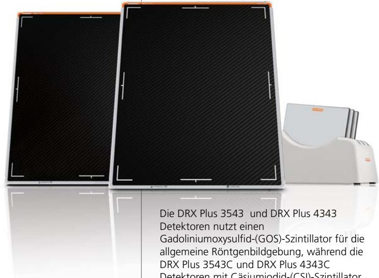
Die DRX Plus 3543 und DRX Plus 4343 Detektoren nutzen einen Gadoliniumoxysulfid-(GOS)-Szintillator für die allgemeine Röntgenbildgebung, während die DRX Plus 3543C und DRX Plus 4343C Detektoren mit Cäsiumiodid-(CsI)-Szintillator ideal für die Pädiatrie oder andere strahlungsempfindliche Anwendungsbereiche sind.
